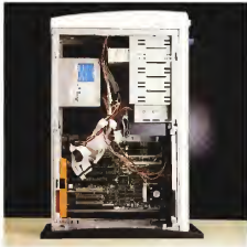
A sinistra: una vista generale della macchina aperta. A destra: un particolare del meccanismo «chiave-reflex» che consente di fissare le schede di espansione senza l'uso di viti
